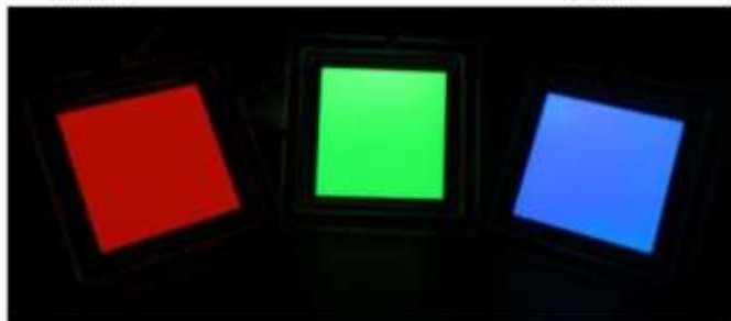
スプレー塗布を用いた有機ELデバイス試作品
