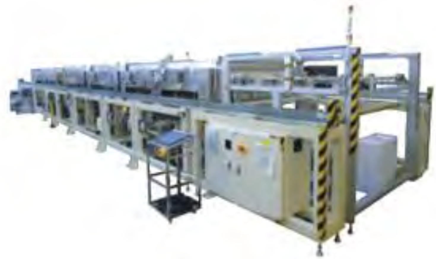
LIA (Low Inductance Antenna) プラズマCVD/スパッタ装置 対応基板サイズ(例) W 1,400mm × L 1,100mm
