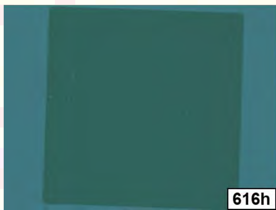
40°C/90%RHで616時間保存後のCaテストデバイス (バリア層膜厚さ: 720nm)
