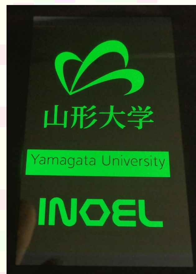
40°C/90%RHで616時間保存後のCaテストデバイス (バリア層膜厚さ: 720nm)
