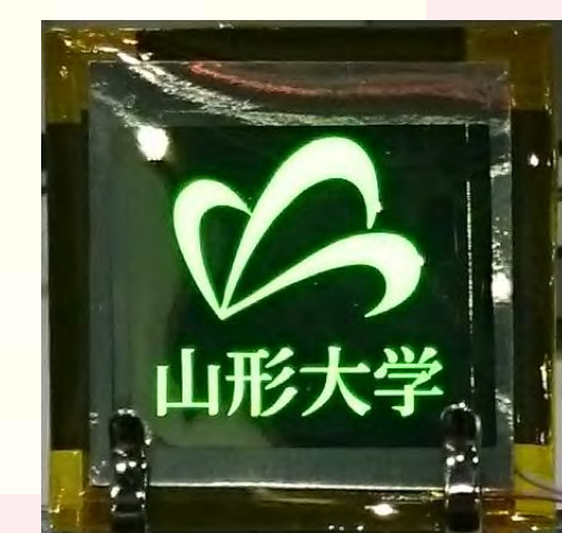
フレキシブル有機ELデバイス (山形大学) バリアレジスト: tesa
