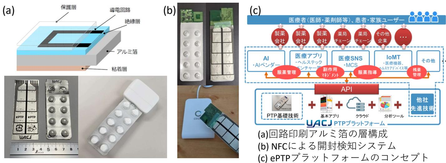
導電回路を印刷したアルミ箔と通信デバイスを利用した開封検知・通知システムを開発。開発したクラウドプラットフォームはBluetooth、LPWA、NFCといった通信システムと互換性があり、医薬品のPTP包装 (press through package) だけでなく様々な分野への適用が期待されます。適用分野拡大のため、開封検知に対するニーズをお持ちのビジネスパートナーを探したいと思います。お気軽にお声掛けください！
