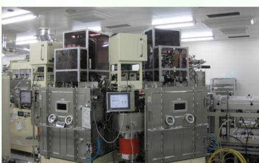
30cm角基板対応有機EL蒸着装置
