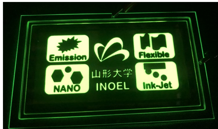
有機ELディスプレイの試作品 外形: 100mm × 60mm (山形大学 YU-FLEC)
