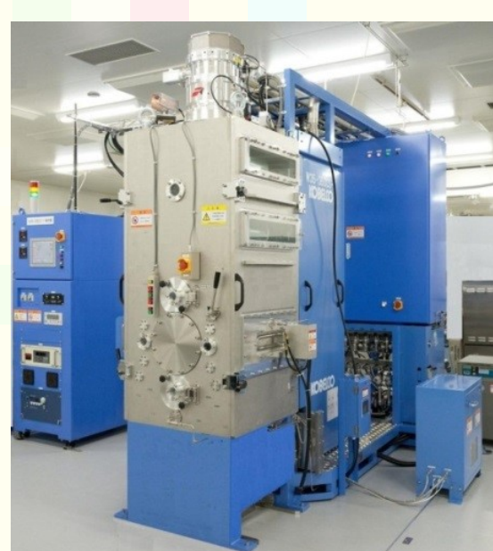
R2R sputtering & CVD (KOBELCO)
