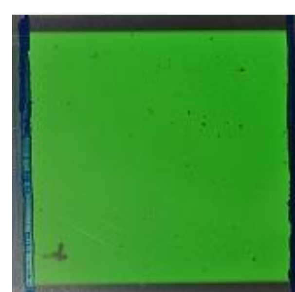
基板サイズ : 50mm X 50mm 発光エリア : 32mm X 32mm
