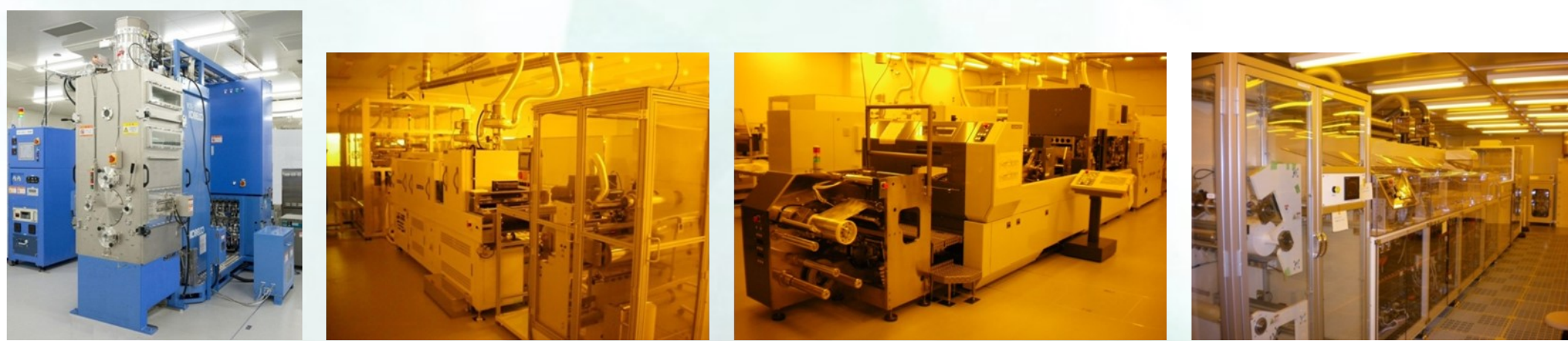
スパッタ&CVD（神戸製鋼所） スクリーン印刷（東海商事） グラビアオフセット&フレキソ印刷（小森マシナリー/太陽機械） ウェット洗浄（FEBACS）
