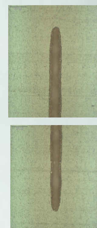
新方式印刷機 30μm線が正確に再現
