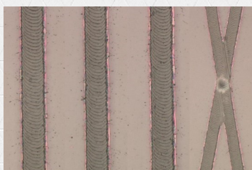
TCOのレーザー加工例
